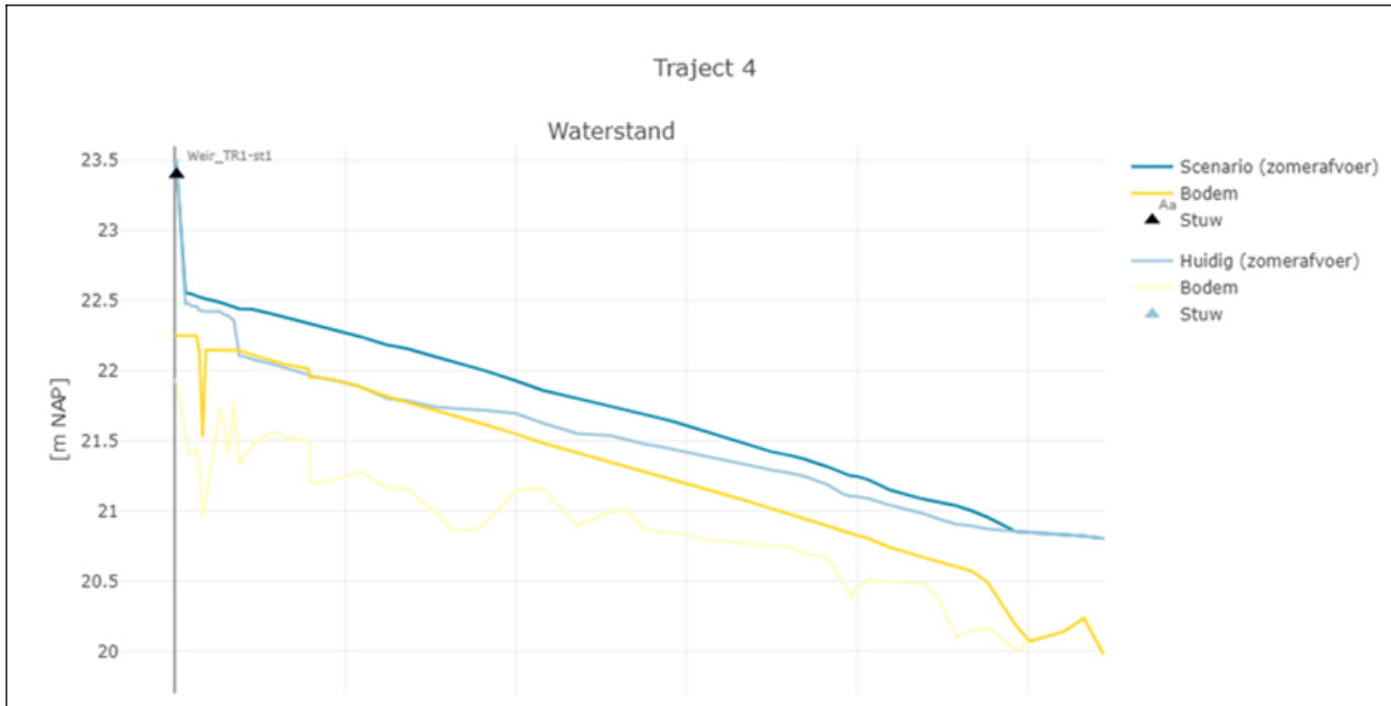
Figuur 1.5-2 Peilstijging als gevolg van verhoging van de beekbodem
